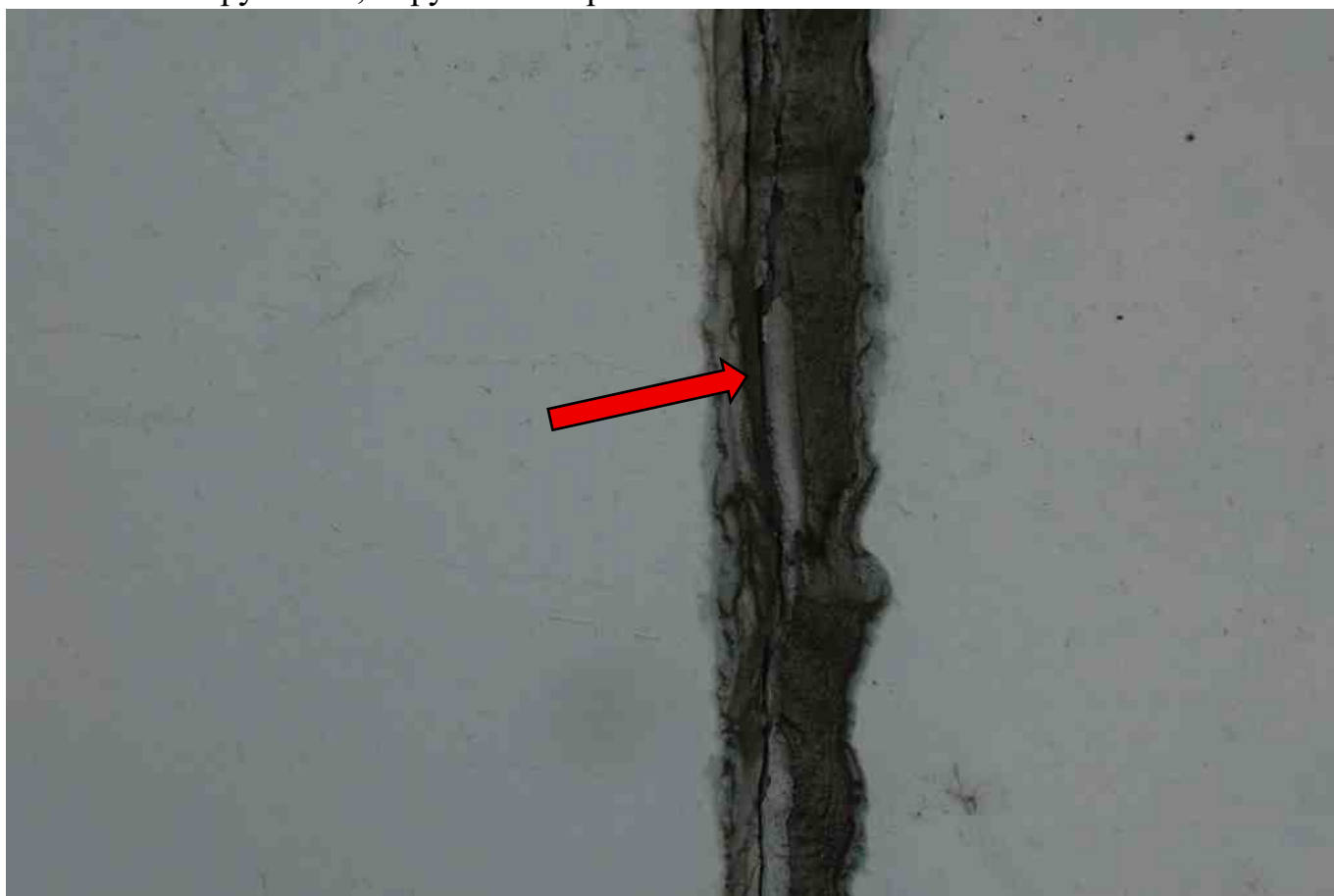
Фото 263. Разрушение, нарушение герметичности шва.
